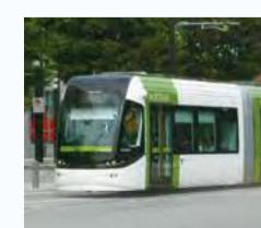
※LRT(エル・アール・ティー)とはLight Rail Transitの略で、次世代型の路面電車。車両の床が低く平らで、ホーム(乗り場)との間に段差や隙間がほとんどなく、騒音や振動が少ない、また専用レーンを走るため、定時性、速達性などに優れた特徴をもつ交通システム。
