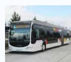
※BRT(ビー・アール・ティー)とはBus Rapid Transitの略で、バス専用道やバスレーン、バスが通る時に優先的に信号が青に変わるPTPS(公共車両優先システム)、連接バスなどを組み合わせることにより、定時性・速達性の確保や輸送能力の増大が可能となるバスシステム。
